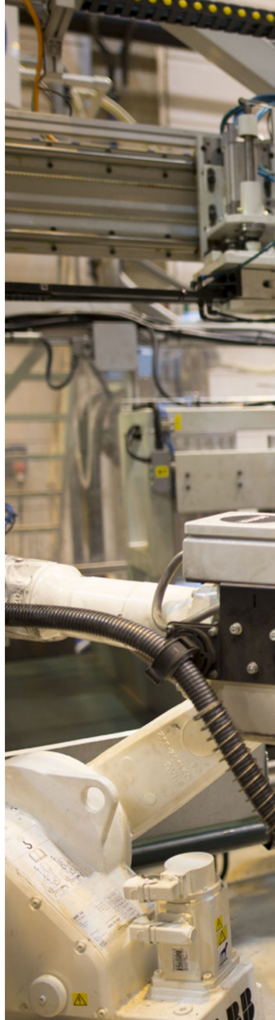
Automatisering. Blowtech i Kongsvinger lager luftkanaler til kjøretøy ved teknisk forblåsning i plast. En ny, robotisert produksjonslinje har økt bedriftens konkurransekraft. Foto: Geir Olsen
