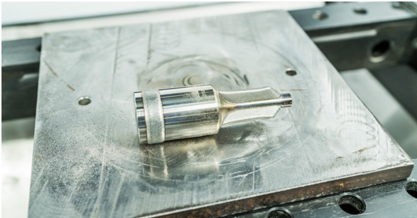
Rustet for røffe forhold: Drivakslingen på bildet har fått et belegg for å tåle belastningen av både olje og saltvann i maritim sektor. Arbeidet er utført av 3D-skriveren hos Nordic Additive Manufacturing på Raufoss. Foto: Ricardofoto.no
